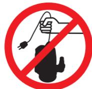
Nunca debe instalar su bomba de manera que cuelgue libremente de la tubería a presión o del cable de corriente. Deberá sujetarla bomba por el cable provisto para tal efecto.
