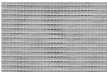
Malla de fibra de vidrio indicada para el refuerzo de morteros en Sistema de Aislamiento Térmico Exterior (SATE - ETICS).
