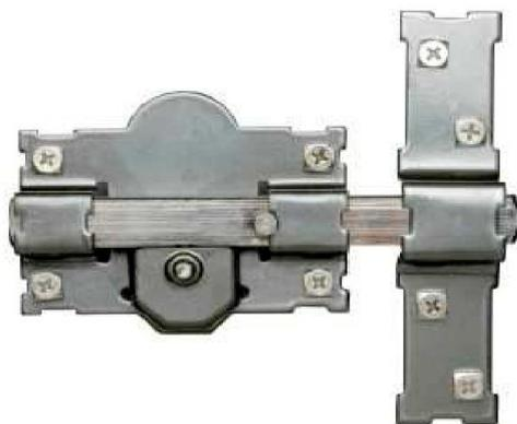
Se trata de un dispositivo metálico de uso fundamentalmente residencial, de instalación tanto en interior, como en exterior, que se fija en las puertas y que su función principal es mantenerlas cerradas, compuesto fundamentalmente por una barra de acero con un tirador) montada en un soporte (placa). El cierre se efectúa al introducir la barra en el cerradero, colocado éste en el marco de la puerta.
