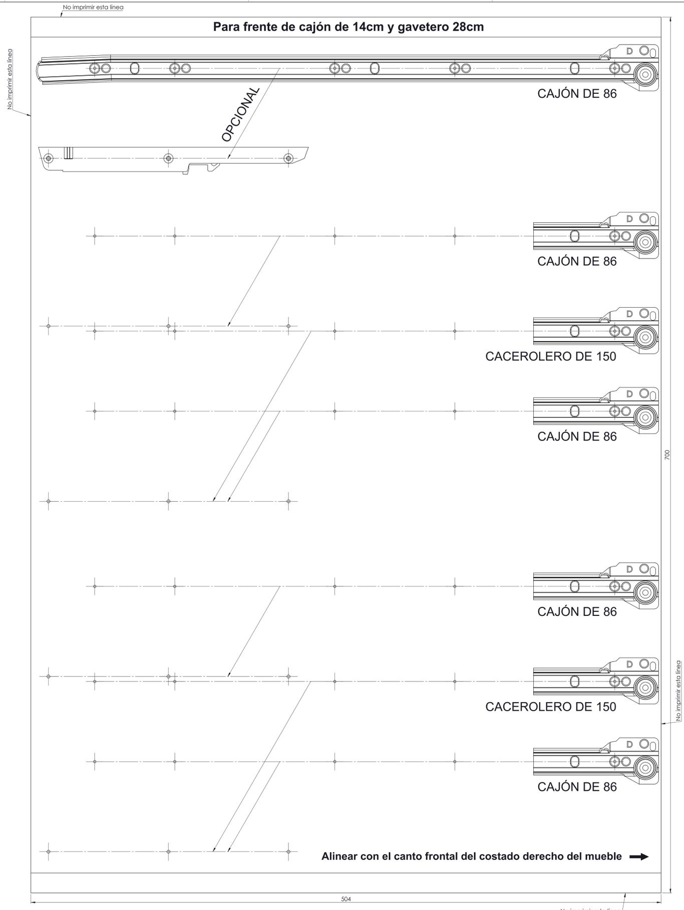
Plantilla de 504x700mm, impresa en papel mate 100grs por ambas caras (impresa sin las 4 líneas exteriores, ni en una cara ni en la otra) a escala 1:1, doblada en cruz hasta dejar a 252x350mm con la referencia a la vista
