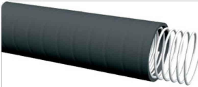
Tubería de pvc flexible con superficie interior y exterior totalmente lisas reforzada con espiral de pvc rígida prácticamente indeformable y antichoque.
