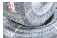
Los rollos, deben almacenarse horizontalmente y siempre a cubierto, ya que la exposición continuada del film protector a la luz del sol, genera unas altas temperaturas, muy por encima de las que resiste el material, que puede llegar a deformarse.
