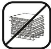
Los soportes entre los diferentes paquetes deben quedar bien alineados para una buena distribución del peso, evitando así deformaciones en el material.
