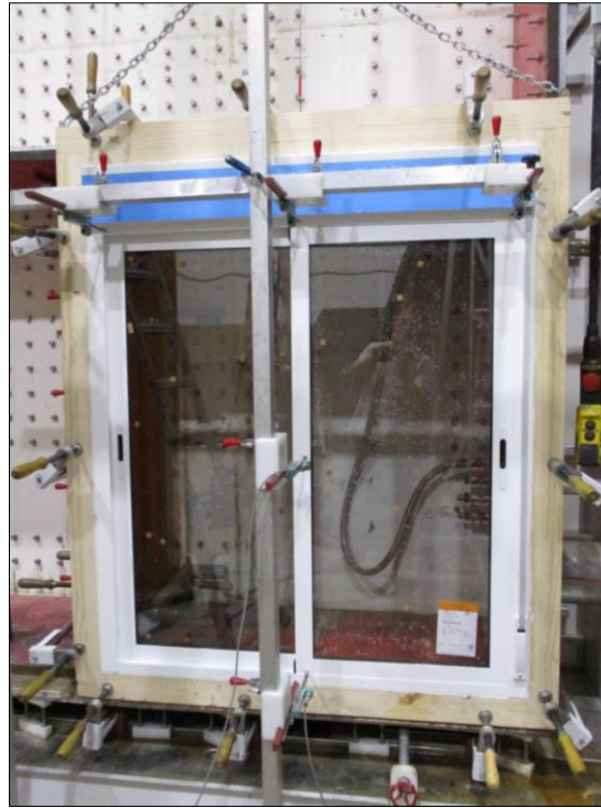
Foto N°.5. Detalle de la posición de los transductores
