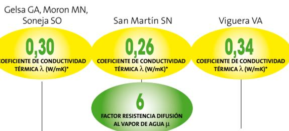
\* Determinación de la conductividad térmica según las pautas definidas en la UNE-EN-13.279-1: 2006, correspondiente a material seco aplicado en interiores. (23°C y 50% de humedad relativa). Valor para el cálculo de parámetros característicos y particiones interiores según el CTE-DB HE-1.
