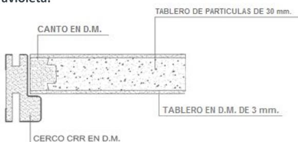
**Vidrieras:** tienen la misma composición estructural que las ciegas y al final del proceso de fabricación se realiza un vaciado donde se inserta, en cada una de las caras, un bastidor de molduras de tablero de fibras (d.m.) recubierto con una papel prelacado al que se aplica una mano de laca de terminación con pigmentaciones blancas iguales a las aplicadas en la hoja. El bastidor de una cara va suelto para facilitar la inserción del cristal.
