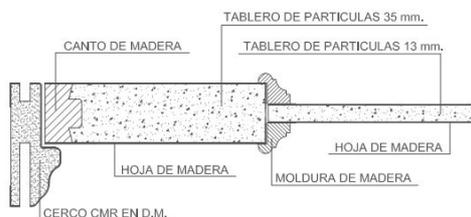
**Vidrieras:** tienen la misma composición estructural que las ciegas. El bastidor de moldura es de madera maciza de 17mm y el de una cara va suelto para facilitar la inserción del cristal.
