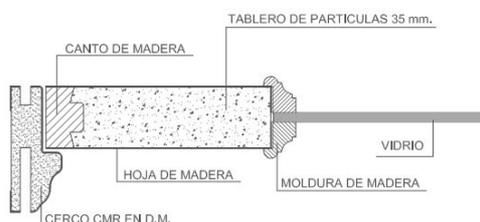
**Cerco:** extensible a dos lados, fabricado sobre un tablero de fibras (d.m.) de 28 mm de espesor y recubierto de chapa natural de la misma especie que la utilizada en la puerta. Finalmente se aplica un barniz ultravioleta.
