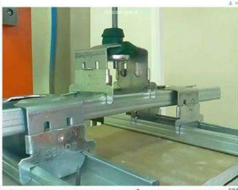
Disposición de ensayo: 235,50 Kg
