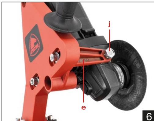
5. Empuje la amoladora angular hacia abajo para ubicar el disco de la amoladora angular en la ranura de corte de la base (a). Ajuste el perno (h) y el perno (i) para que el disco quede ubicado en el medio de la ranura (consulte la Figura 7).
