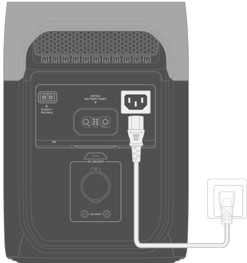
Conecte el puerto de entrada de CA de la estación de energía a un tomacorriente de pared usando el **cable de carga de CA** proporcionado.
