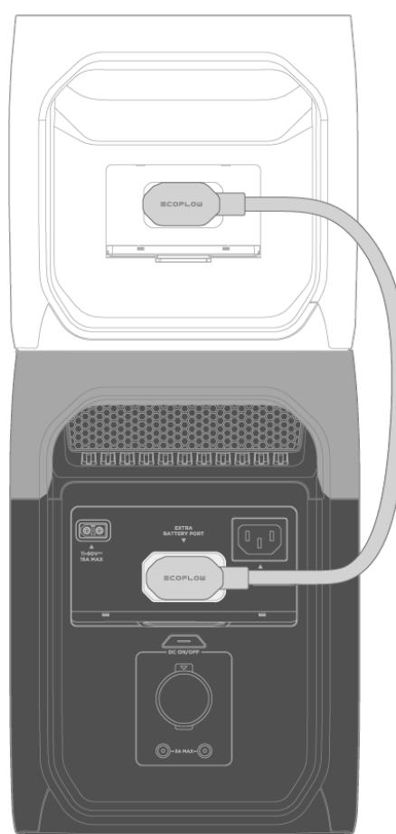
1. Conecte la batería adicional al puerto de la batería adicional de la estación
