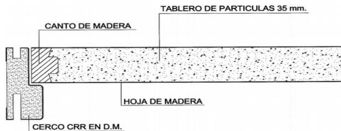
**Vidrieras:** Tienen la misma composición estructural que las ciegas y al final del proceso de fabricación se realiza un vaciado donde se inserta, en cada una de las caras, un bastidor de molduras de tablero de fibras (d.m.) recubierto con chapa de la misma especie que la puerta. El bastidor de una cara va suelto para facilitar la inserción del cristal.
