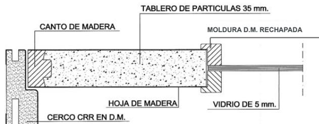
**Cerco:** extensible a dos lados, fabricado sobre un tablero de fibras (d.m.) de 28 mm de espesor y recubierto de chapa natural de la misma especie que la utilizada en la puerta. Finalmente se aplica un barniz ultravioleta.
