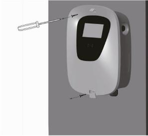
1) Retirar los dos tornillos (M3) de la cubierta frontal, abrir la cubierta frontal y luego retirar los tornillos internos (M6).
