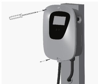
1) Retirar los dos tornillos (M3) de la cubierta frontal, abrir la cubierta frontal y luego retirar el tornillo interior (M6).
