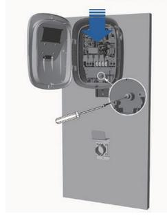
4) Unir la estación de carga en su soporte de arriba hacia abajo, abrir la cubierta de la estación, abrir el tornillo conectado al pasador del soporte.
