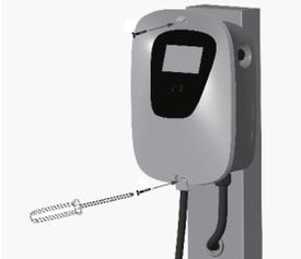
9) Cerrar la tapa de la estación de carga, abrir los tornillos laterales (x2).
