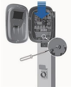
6) Unir la estación de carga en su soporte de arriba hacia abajo, abrir la cubierta de la estación, abrir el tornillo conectado al perno del soporte.
