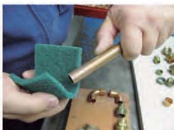
**3** - Preparar las superficies que serán soldadas. Tomar una lija fina y pulir los extremos de las piezas rectas que van a ser soldadas. Pulir hasta que el metal este brillante y limpio. Esto eliminará la grasa, la suciedad y la oxidación evitando que una soldadura pueda tener fugas.
