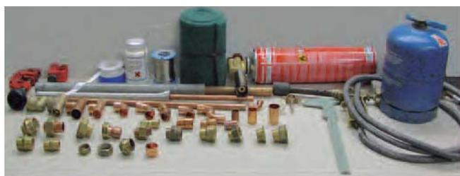
**1** - Planea con anticipación. Determina todos los materiales que necesitarás para completar tu proyecto de fontanería. Asegúrate de que tienes tubería de cobre y accesorios suficiente para hacer todas sus curvas y tramos rectos.
