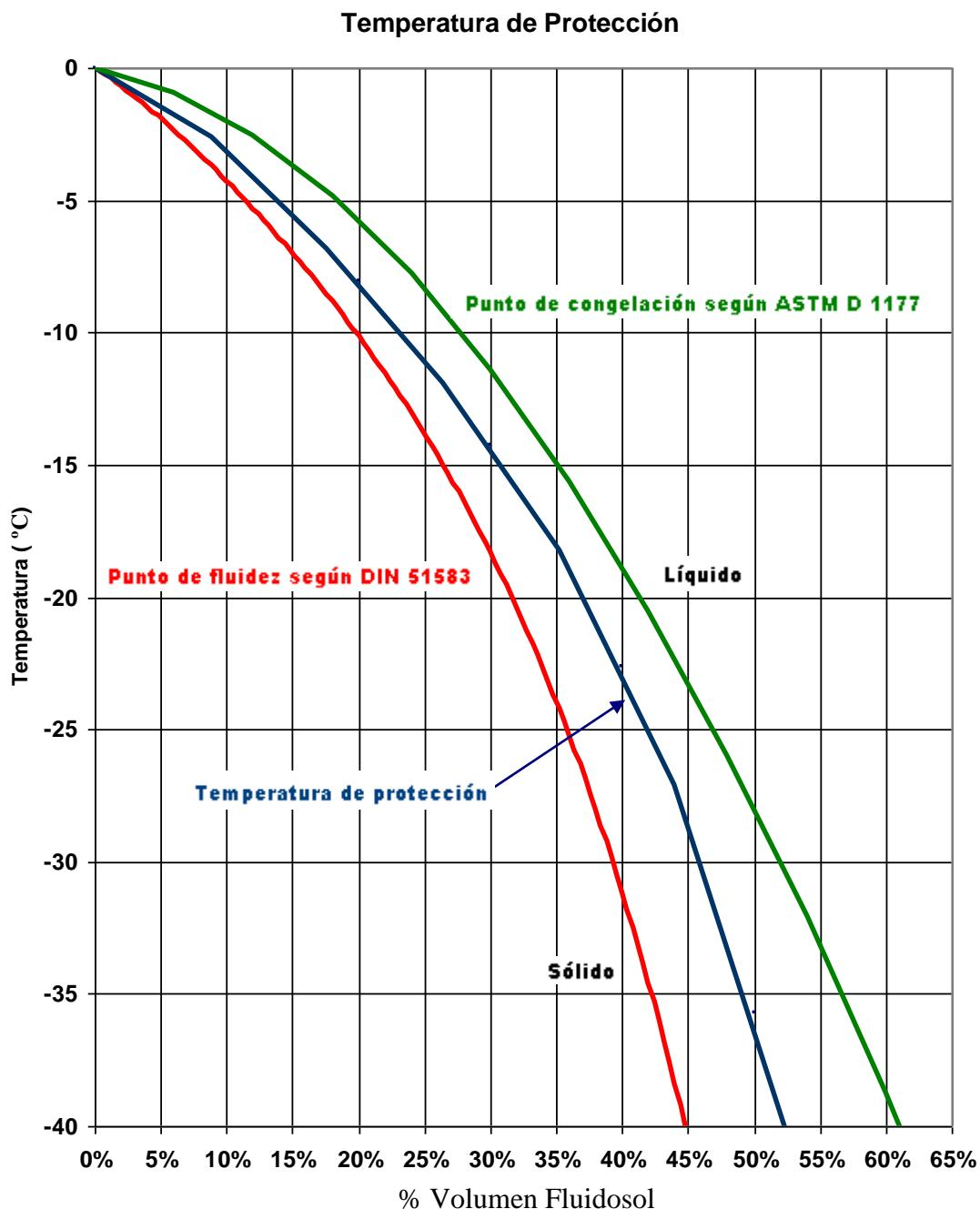
El punto de congelación según la norma ASTM D 1177 indica la temperatura a la que aparece el primer cristal.
