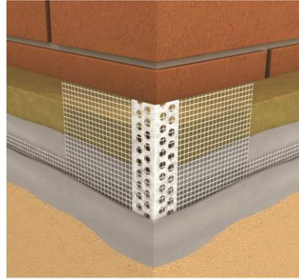
Perfil cantonera de PVC con malla de fibra de vidrio álcali-resistente y certificada ETAG 004, válida para cualquier espesor de mortero, protege los ángulos horizontales y verticales en aristas, ventanas y puertas, ayudando a la formación de cantos perfectos, tanto alineados como perpendiculares.
