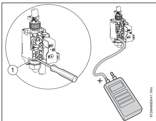
Fig. 66 Punto de medición de presión de entrada
