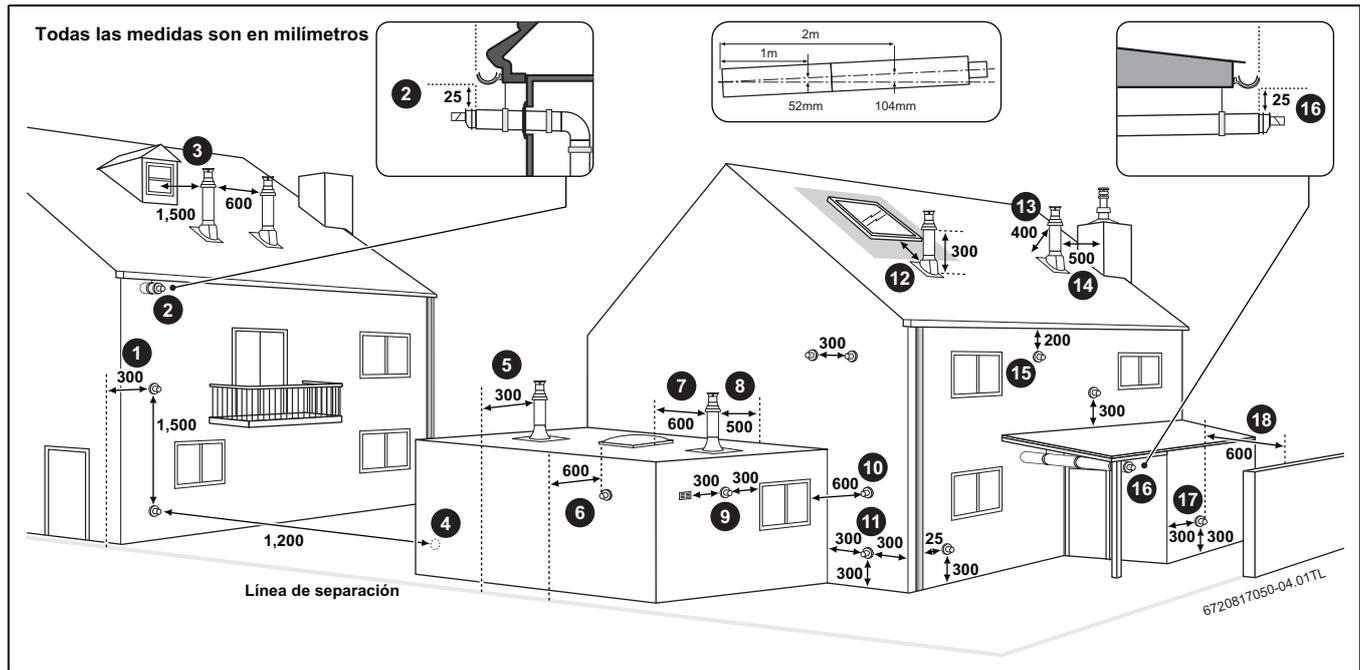
Fig. 20 Posiciones terminales del conducto de evacuación
