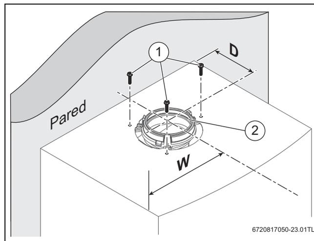
Fig. 48 Centro del adaptador de conducto de evacuación
