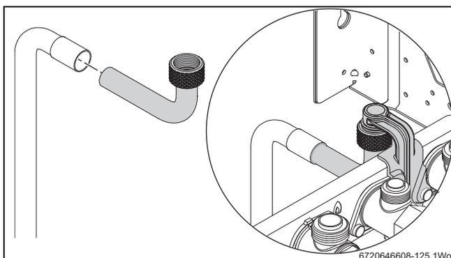
Fig. 41 Empalme acodado de válvula de seguridad
