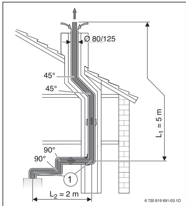
Fig. 29 Situación de montaje de una evacuación de gases según C<sub>33</sub>
