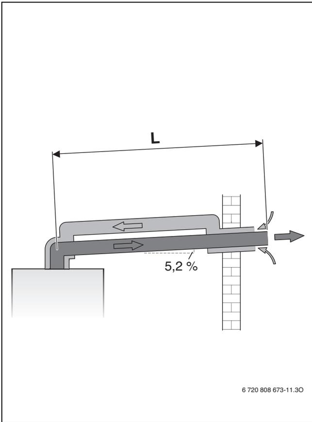
Fig. 25 Evacuación de gases horizontal según C<sub>13</sub>
