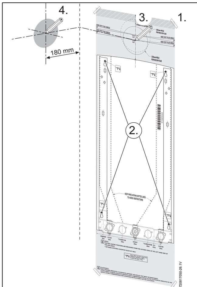
Fig. 34 Marcar la posición del conducto de evacuación
