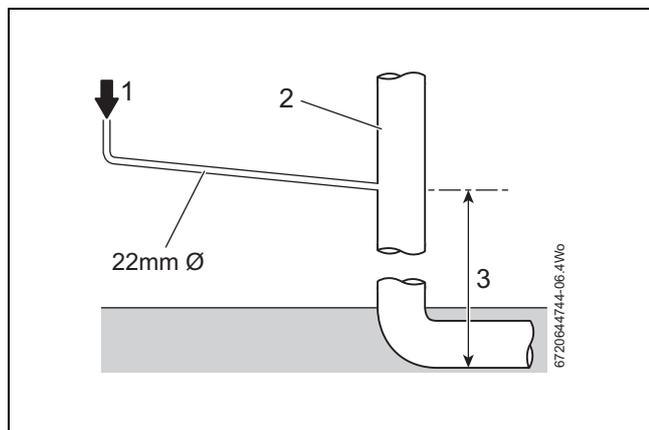
Fig. 8 Eliminación de condensado con orificio de ventilación
