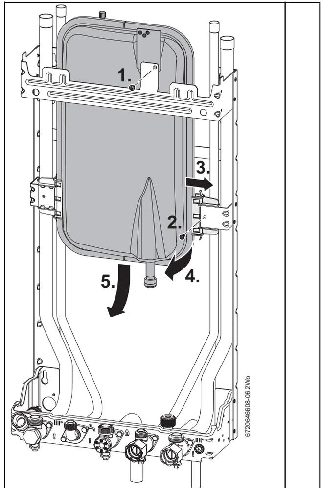
Fig. 88 Retirar el vaso de expansión
