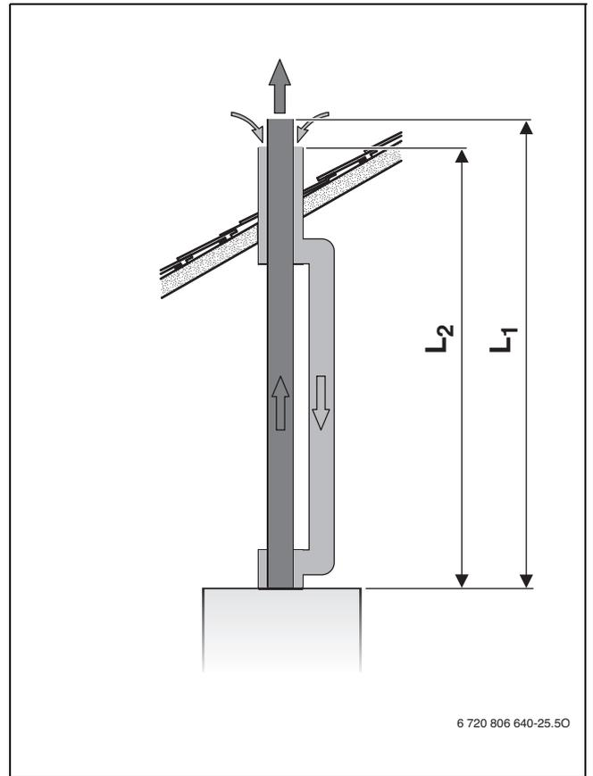
Fig. 27 Evacuación de gases vertical según C<sub>33</sub>
