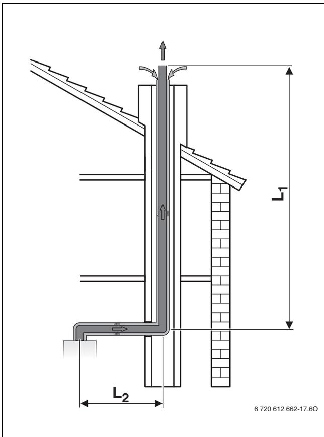
Fig. 22 Evacuación de gases con tubo concéntrico en la chimenea según C<sub>33</sub>
