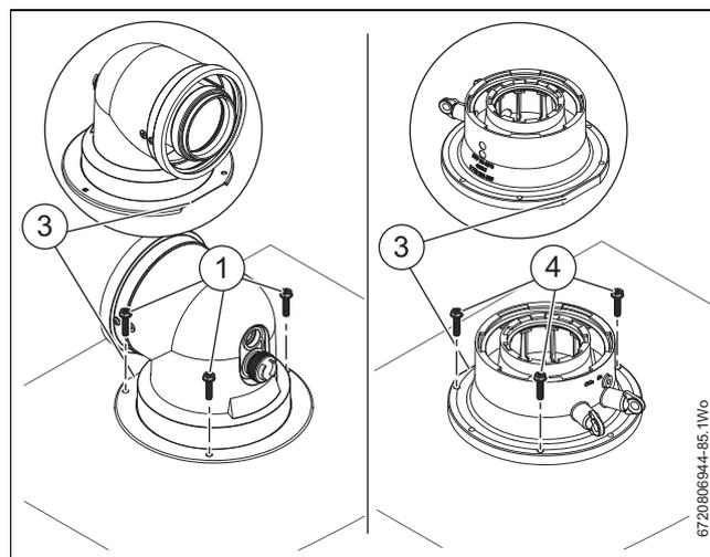
Fig. 49 Conexión del adaptador del conducto de evacuación
