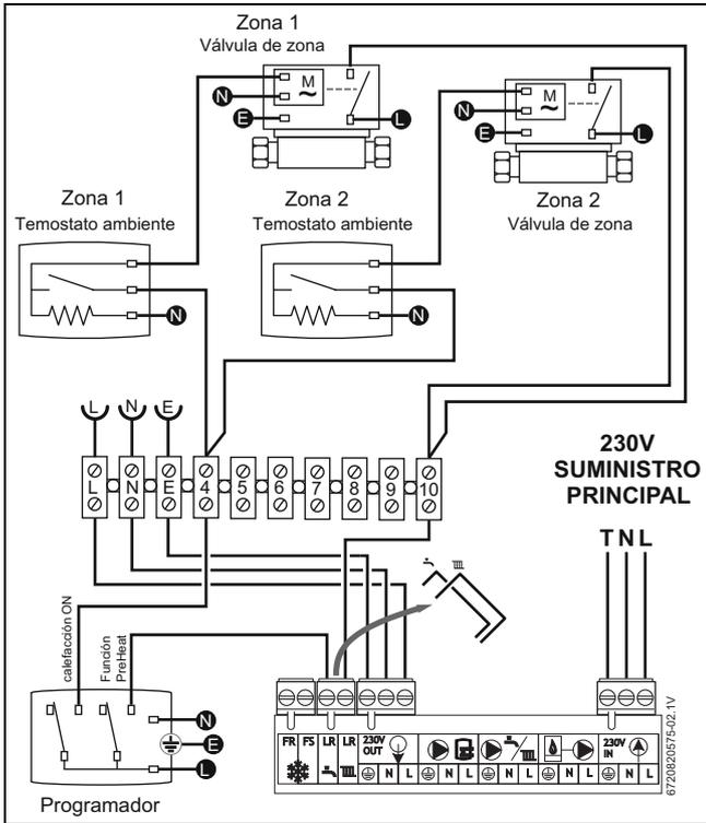
Fig. 57 Dos termostatos ambiente, un reloj conmutador externo
