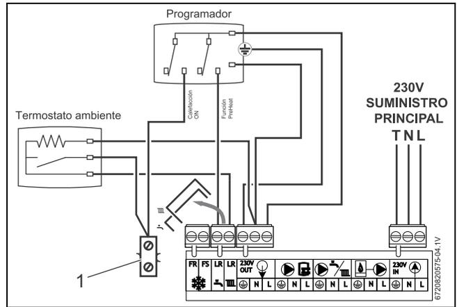
Fig. 59 Termostato del ambiente con programador
