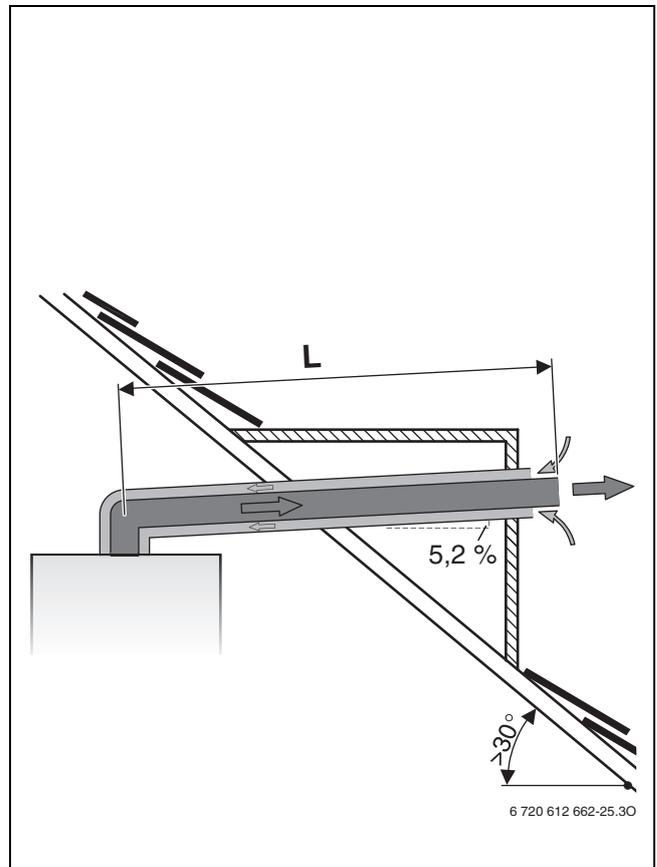
Fig. 24 Evacuación de gases horizontal según C<sub>13</sub>
