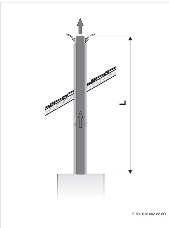
Fig. 26 Evacuación de gases vertical según C<sub>33</sub>
