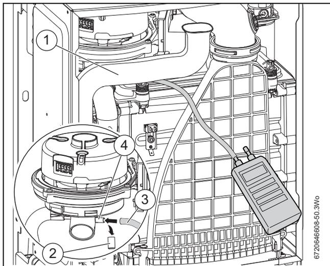
Fig. 77 Punto de medición de presión de ventilador
