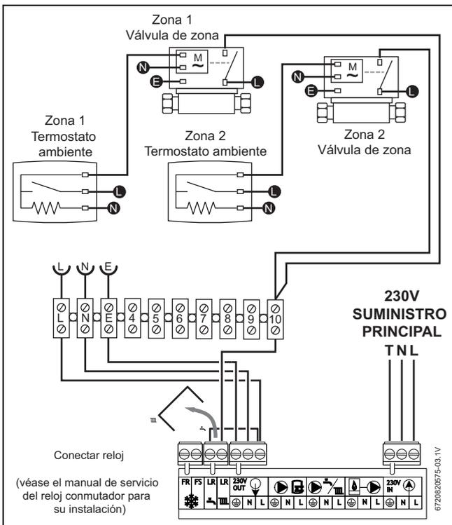
Fig. 58 Dos termostatos ambiente, un reloj conmutador integrado
