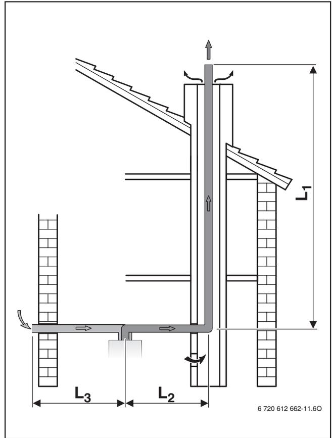
Fig. 23 Evacuación de gases en chimenea según C<sub>53</sub>
