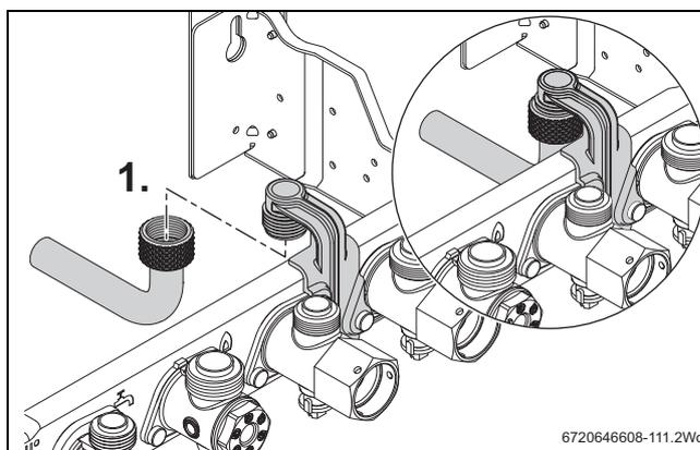
Fig. 40 Conexión de tubería de válvula de seguridad
