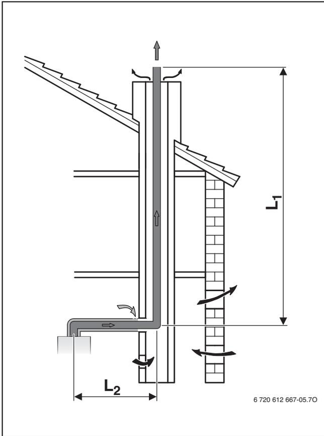
Fig. 21 Evacuación de gases en chimenea según B<sub>33</sub>
