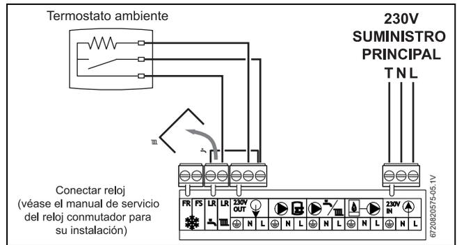
Fig. 60 Termostato ambiente con enchufe en reloj conmutador
