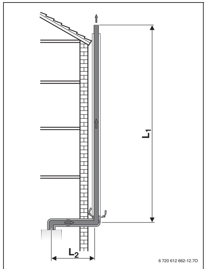
Fig. 28 Evacuación de gases en la fachada según C<sub>53</sub>
