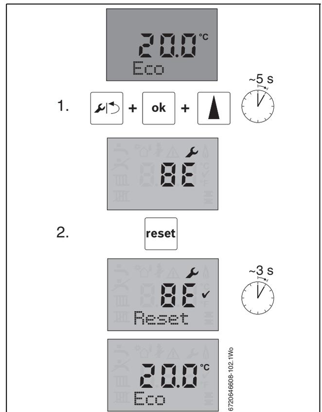
Fig. 92 Reseteo a los ajustes de fábrica
