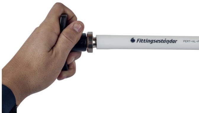
Introducir el calibrador en el tubo hasta el tope de la sección correspondiente al diámetro de la tubería. Girarlo en el sentido de las agujas del reloj y comprobar que el biselado se ha realizado correctamente.
