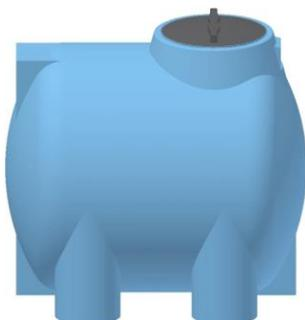
Contenitore cilindrico orizzontale con struttura auto-portante, realizzato in polietilene lineare atossico stabilizzato U.V. di colore azzurro, resistente agli agenti atmosferici. Prodotto con stampaggio rotazionale, monolitico in un unico pezzo senza giunzioni.
