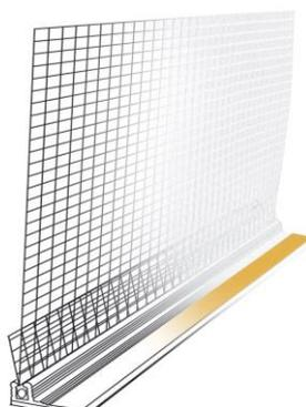
Perfil autoadhesivo marco ventana de PVC con malla de fibra de vidrio álcali-resistente y certificada ETAG 004, permite que el ETICS (SATE) se conecte a los marcos de las aberturas de las estructuras de puertas y ventanas sin dejar huecos ni espacios. Gracias a su lengüeta con adhesivo para papel de protección, una vez retirada, su ejecución es perfecta y limpia.
