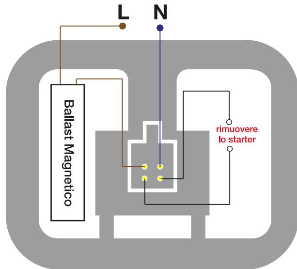
\*Questo LED 2D 4Pin non è adatto per circuiti con ballast elettronico (ECG).
