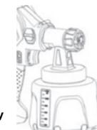
8. Desenrosque la tuerca y retire la válvula de aire y la boquilla
