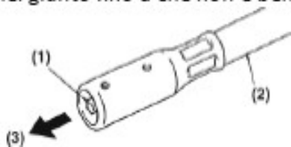
(1) Albero curvo (2) Asta alloggiamento frizione (3)
