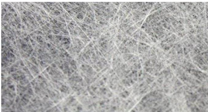
Velo de fibra de vidrio clase C formulado para el refuerzo en impermeabilizaciones de terrazas, cubiertas planas e irregulares, moldeo, piscinas, náutica, etc.
