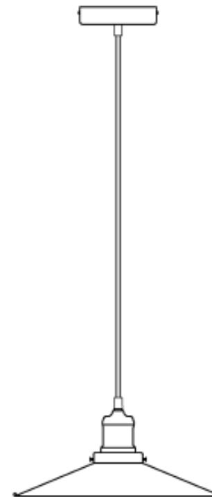
Raccorder les conducteurs en provenance de l'installation et du luminaire au boîtier de raccordement en reliant la terre sur le plot centrale : ce luminaire de classe 1 doit être relié à la terre
