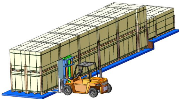
Scarico della confezione orizzontale con carrello elevatore
