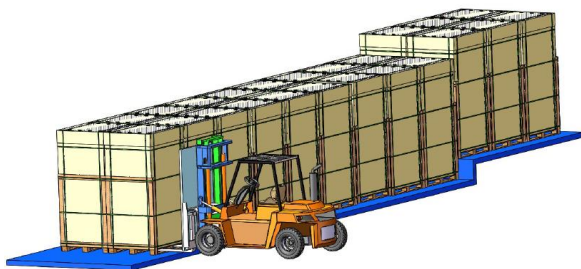
Scarico della confezione verticale con carrello elevatore
