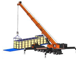
Scarico della confezione verticale con la gru
