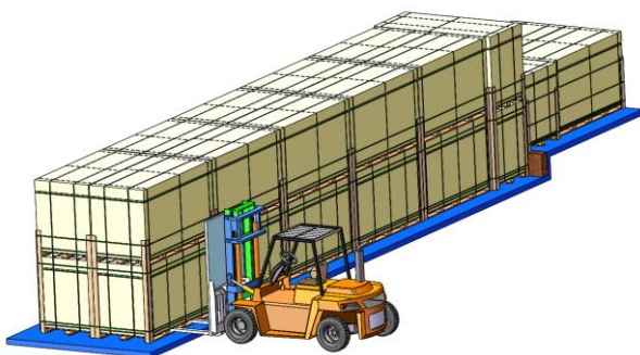
Scarico della confezione orizzontale con carrello elevatore
