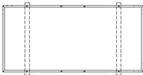
Fig. 4 Instalación con pernos para 66 células
