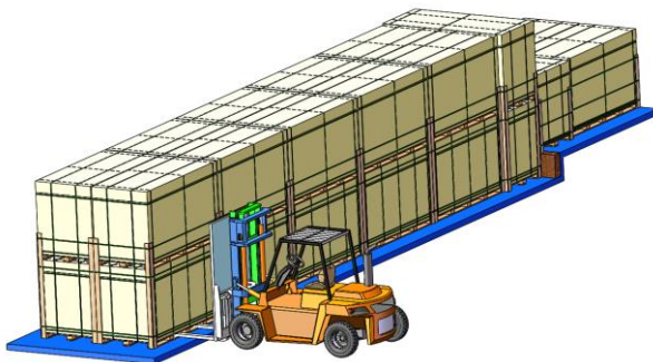
Descarga de bultos embalados horizontalmente con una carretilla
