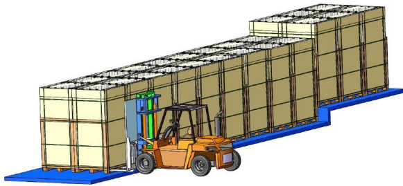
Descarga de bultos embalados verticalmente con una carretilla
