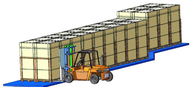
Descarga de bultos embalados verticalmente con una carretilla
