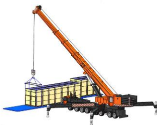
Descarga de bultos embalados verticalmente con una grúa
