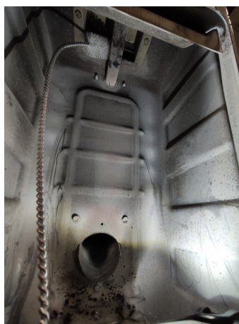
Fig. 86 - Nettoyer avec un goupillon.
