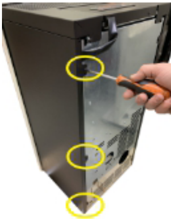
Fig. 41 - Retirer les vis
