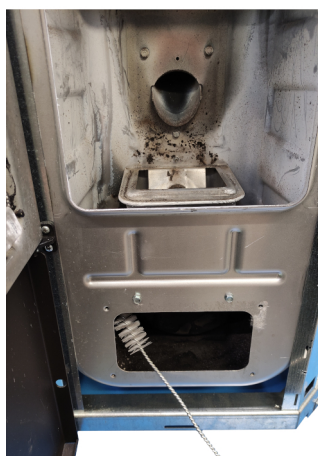
Fig. 84 - Nettoyer avec un goupillon.
