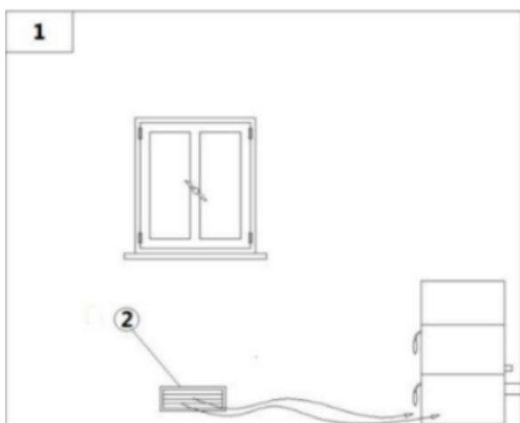
Fig. 8 - Entrée d'air directe
