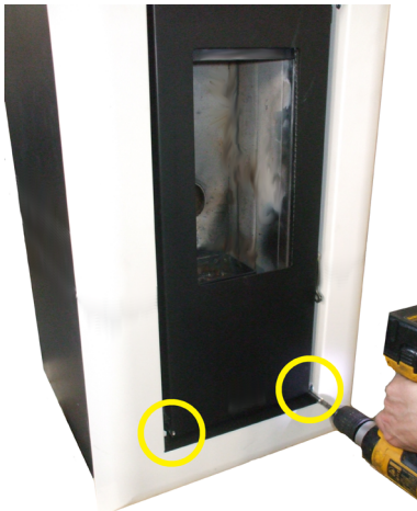
Fig. 38 - Retirer les vis
