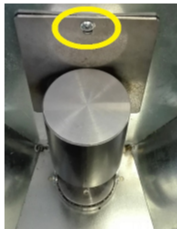
Fig. 91 - Retrait des vis
