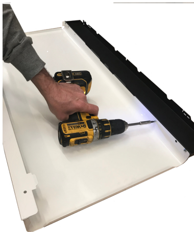
Fig. 48 - Fixer le flanc coloré
