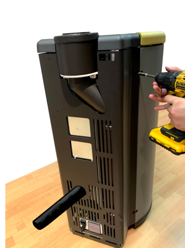
Fig. 70 - Tuyau d'air dissocié
