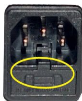
Fig. 89 - Hublot avec les fusibles à enlever
