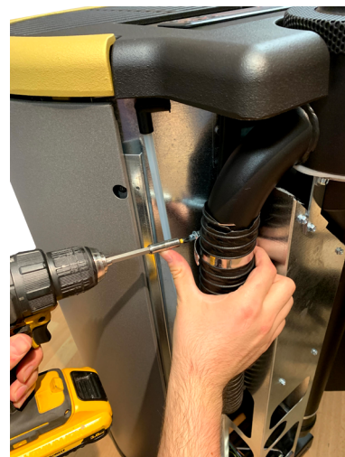
Fig. 67 - Extraire le tuyau flexible
