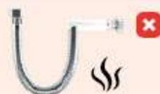
No instale flexibles en tensión o torsión.
