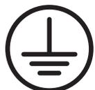
Terminal del conductor de tierra de protección (puesta a masa)
