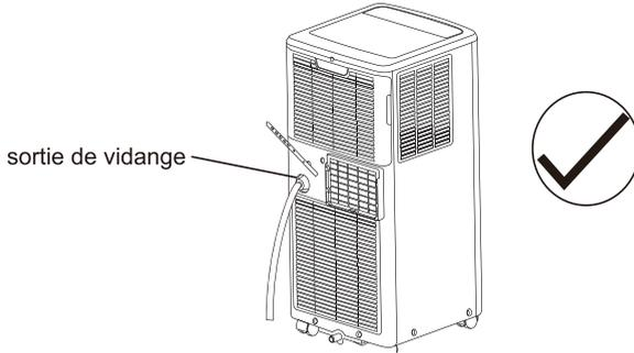
Remarque : Assurez-vous que le tuyau est sécurisé et qu'il n'y a pas de fuites. Dirigez le tuyau vers le drain après avoir vérifié qu'il n'y a pas de plis qui empêcheraient l'écoulement de l'eau. Placez l'extrémité du tuyau dans le drain de sorte que l'extrémité du tuyau est vers le bas pour permettre à l'eau de s'écouler en douceur. Ne la laissez jamais vers le haut.
