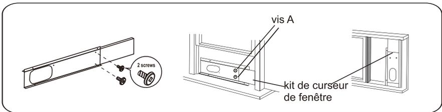
Fixez le kit de glissière pour fenêtre au châssis de la fenêtre. Ajustez la longueur du kit : Desserrez la vis A pour ajuster la longueur du kit de glissière pour fenêtre, puis serrez la vis lorsque vous trouvez la longueur appropriée.
