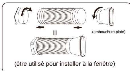
2. Connectez le conduit d'évacuation au connecteur d'expulsion de l'air à l'arrière de l'appareil. Faites glisser l'adaptateur A vers le bas jusqu'à ce qu'il s'enclenche.
