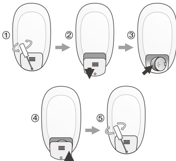
1. Retirez la vis à l'arrière de la télécommande.
