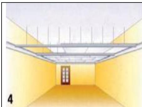
Hay que disponer los puntales y los regles y proceder el replanteo de las placas, cuidando las uniones de las placas longitudinalmente en el sentido de la luz rasante y las uniones transversales alternadas.
