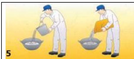
Se amasará a saturación, colocando el agua en la artesa y espolvoreando escayola lentamente para que no se formen grumos, hasta que la escayola quede enrasada con el agua, procediendo primero a su amasado y después, a batir la masa.
