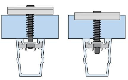
Introducir la parte inferior del presor en el perfil G48 y alinear salientes del presor en la ranura del perfil.
