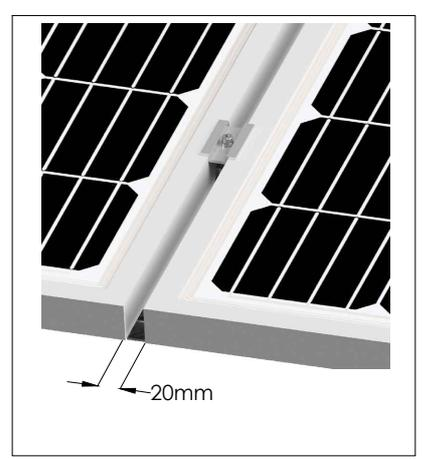
Válido para medidas de espesor de módulo de 28 mm a 40 mm. Para espesores diferentes solicitar bajo pedido.
