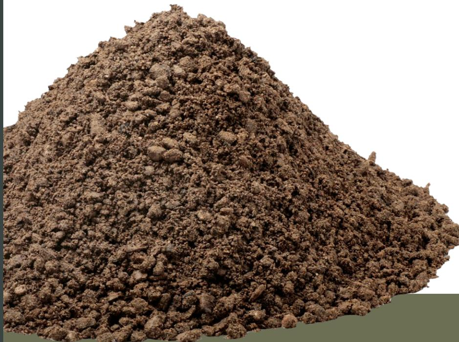
Árido formato por la combinación de diferentes tipos de áridos y gravas, especialmente seleccionados. Esta mezcla de áridos de procedencia calcárea está sometida a procesos previos de trituración, clasificación y lavado.
