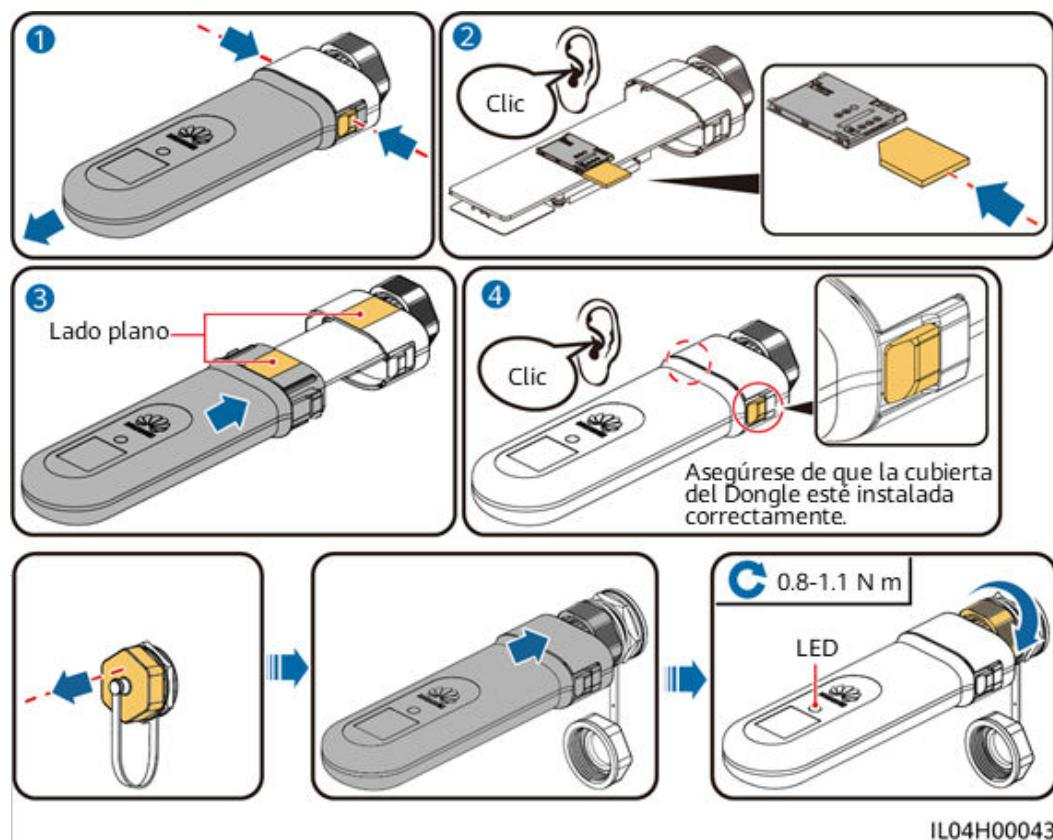
Figura 5-37 Instalación de componentes antirrobo para el Smart Dongle
