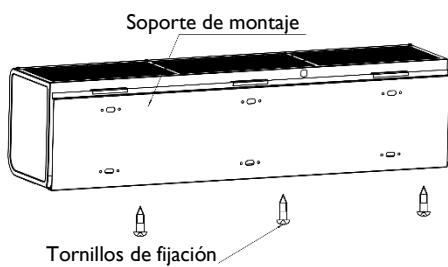
**2.2.2** Decida la posición de instalación y utilizando el soporte de montaje como plantilla, practique los agujeros necesarios en la pared para su correcta instalación.
