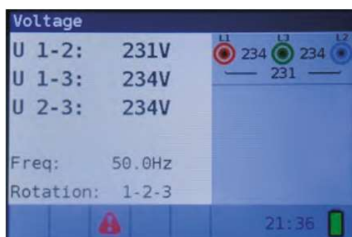
Figura 4 31: Ejemplo de resultado de la comprobación de la secuencia de fase
