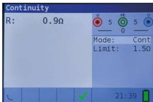
Figura 4 10: Ejemplo de resultado de la medición de continuidad con baja corriente
