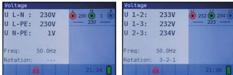
Figura 4 34: Ejemplos de mediciones de tensión y frecuencia
