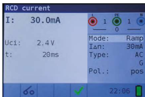
Figura 4 17: Ejemplo de resultado de la medición de la corriente de disparo
