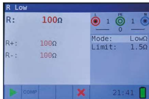
Figura 4 7: Ejemplo de resultados de medición R Baja
