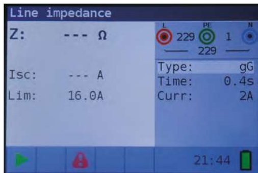
Figura 4 26: Menú de la medición de la impedancia de línea
