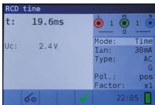
Figura 4 15: Ejemplo de resultado de la medición del tiempo de disparo
