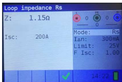
Figura 5 -34 4: Ejemplo de resultados de medición de impedancia de bucle de defecto utilizando la función Rs
