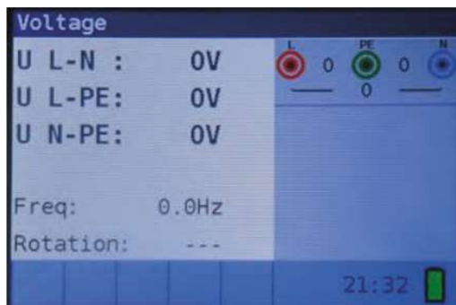
Figura 4 32: Menú de medición de tensión y frecuencia
