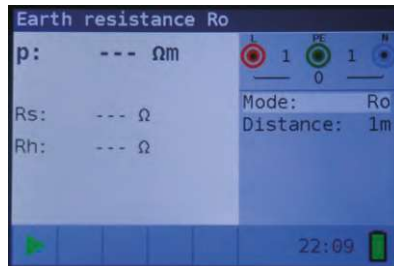
Figura 4 39: Menú de medición de la resistividad del terreno (Ro)
