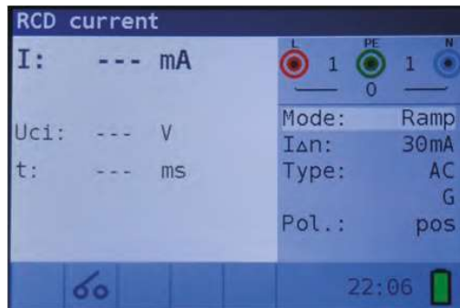
Figura 4 16: Menú de medición de la corriente de disparo
