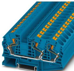
Borne de paso, tensión nominal: 1000 V, corriente nominal: 76 A, número de conexiones: 3, tipo de conexión: Conexión push-in, Sección de dimensionamiento: 16 mm<sup>2</sup>, sección: 0,5 mm<sup>2</sup> - 25 mm<sup>2</sup>, clase de montaje: NS 35/7,5, NS 35/15, color: azul
