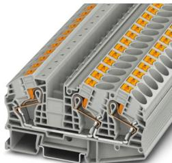
Borne de paso, tensión nominal: 1000 V, corriente nominal: 76 A, número de conexiones: 3, tipo de conexión: Conexión push-in, Sección de dimensionamiento: 16 mm<sup>2</sup>, sección: 0,5 mm<sup>2</sup> - 25 mm<sup>2</sup>, clase de montaje: NS 35/7,5, NS 35/15, color: gris
