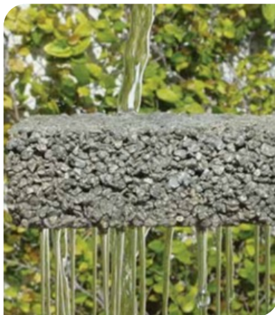
Betão poroso e piso com utilização de betão poroso
