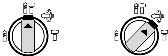
Perfuração por percussão
