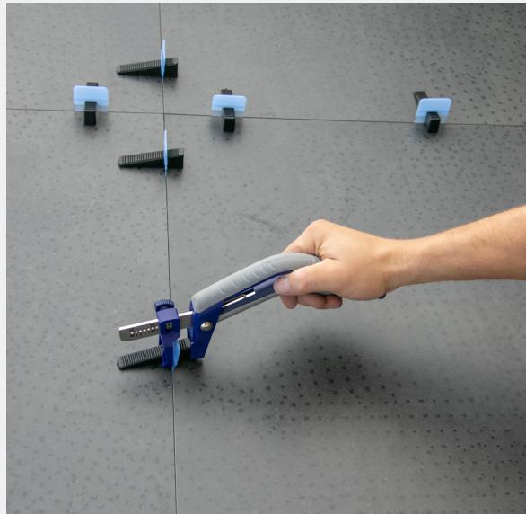
El Alicate Ergonómico Peygran minimiza el cansancio y las lesiones por sobrecarga muscular en los trabajos de alicatado y solado. Evita los problemas provocados por los movimientos de flexión de las muñecas al alinear los ejes de rotación y empuje con los ejes del brazo.
