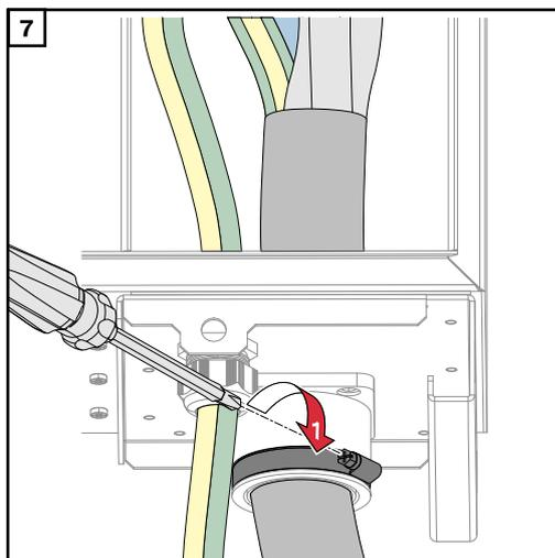
Fijar con el par especificado por el fabricante
