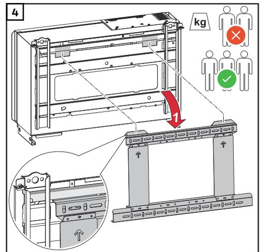
Observar las disposiciones locales para levantar cargas pesadas, o usar una grúa para levantar el equipo por las argollas.
