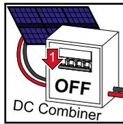
Antes de trabajar en la zona de conexión del inversor se debe desconectar la tensión CC. Esto también se puede hacer en la caja de protección CC.
