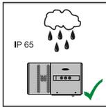
El inversor resulta adecuado para el montaje en zonas exteriores.
