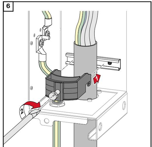
Asegúrelo con el torque especificado por el fabricante del dispositivo de descarga de tracción. La descarga de tracción no forma parte del alcance de suministro.
