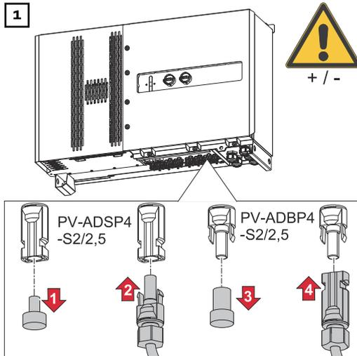
Conectar los cables fotovoltaicos de los módulos solares a los conectores enchufables MC4 según la rotulación
