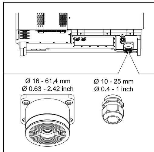
Para la guía de paso más grande se pueden usar cables con los siguientes diámetros exteriores:
