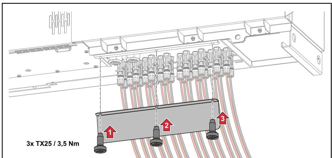
**Conexión del cable fotovoltaico - Pre-combined**
