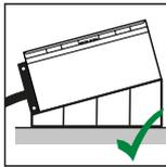
En una posición de montaje horizontal, el inversor debe tener una inclinación mínima de 3° para que el agua pueda correr. Se recomienda montar los Floor Racks opcionales. Los Floor Racks solo se pueden utilizar en una posición de montaje de 0-45°.
