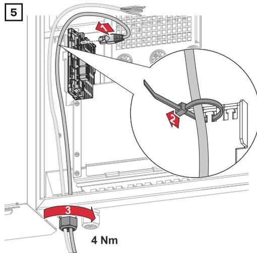
Conectar los cables de datos a la zona de comunicación de datos con un bucle de movimiento y fijar la tuerca de sombrerete con un valor mínimo de 2,5 y un valor máximo de 4 Nm.
