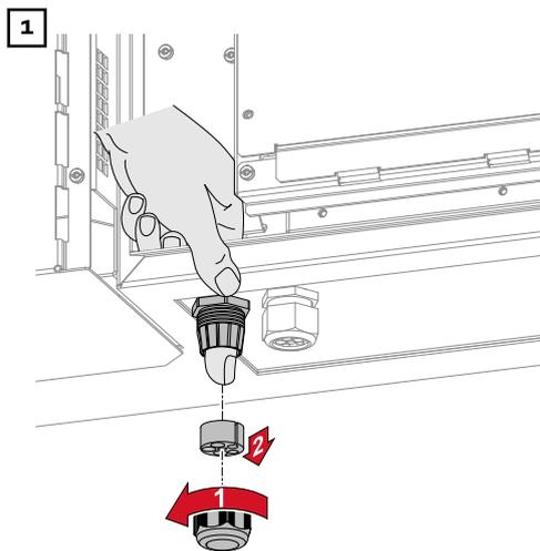
Aflojar el racor de la descarga de tracción y presionar el anillo de junta con los tapones ciegos desde el interior del dispositivo.
