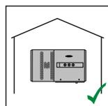
El inversor resulta adecuado para el montaje en zonas interiores.
