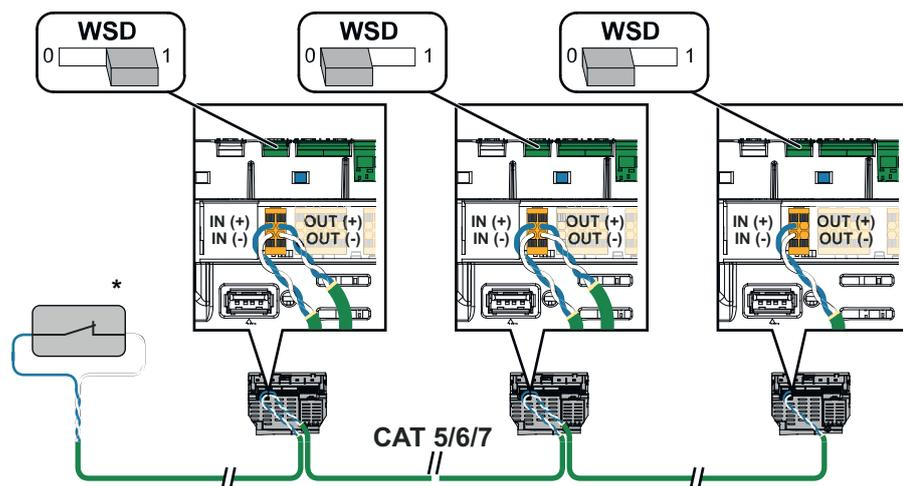
\* Contacto libre de potencial del dispositivo de activación (p. ej. protección central NA). Si se utilizan varios contactos libres de potencial en una cadena WSD, deben conectarse en serie.
