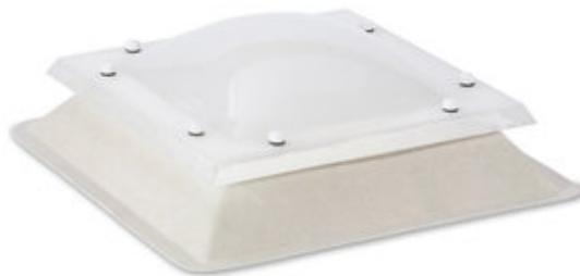
Claraboya fija , destinada a iluminación cenital. Compuesta por cúpula y valva de metacrilato (PMMA) de 3mm de espesor y zócalo de poliéster reforzado (PRFV) tipo sandwich de 15cm de altura, aislado térmicamente con espuma de poliuretano con el fin de obtener mayor resistencia y un alto índice de aislamiento. Instalación en cualquier cubierta y en todo tipo de edificaciones.
