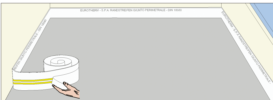
Figura 3: Poner la tira perimetral alrededor de la pared, de manera que se hagan bien los ángulos en los rincones.
