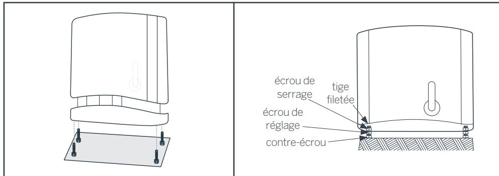
Lorsque le moteur est bien horizontal, serrez les contre-écrous pour bloquer l'écrou de serrage puis serrez les écrous de serrage pour maintenir le moteur en position.
