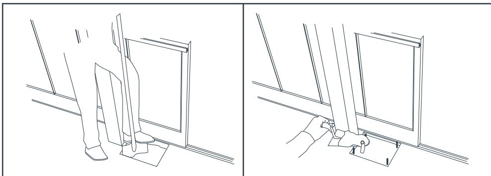
Les broches doivent correspondre au gabarit de pose fourni, attendez que le scellement soit bien sec avant de monter le moteur.
