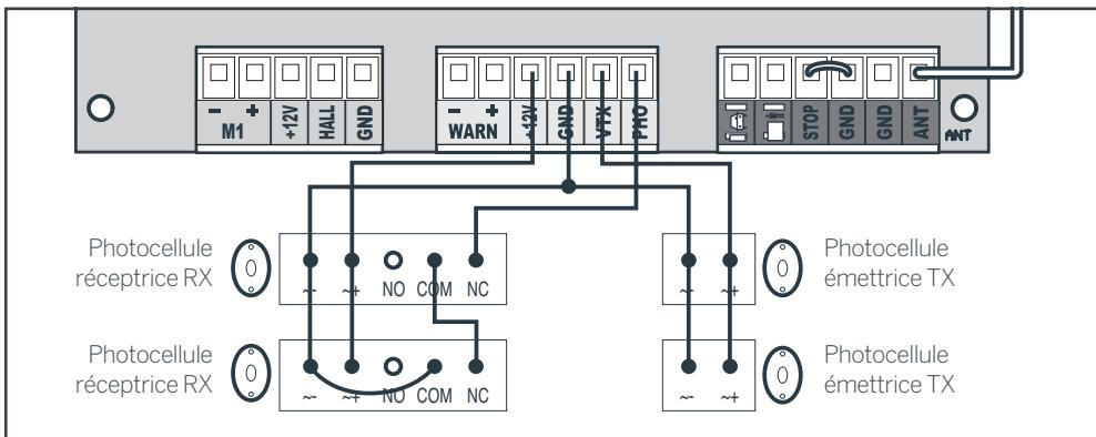
Protection bords primaires et secondaires : dans le cas précédent, le deuxième jeu ne peut pas être monté pour protéger le bord secondaire du portail pendant l'ouverture. Pour ce type de fonctionnement, brancher le deuxième jeu de photocellules sur l'entrée « arrêt d'urgence » comme montré ci-dessous :
