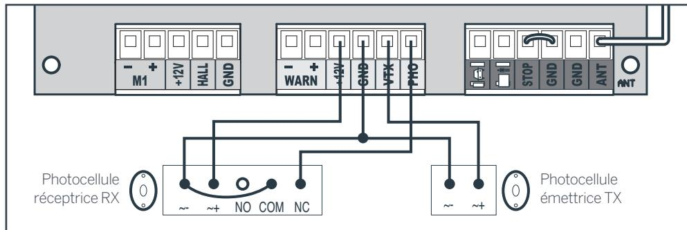
Quand les photocellules sont alimentées, un voyant rouge est allumé à l'intérieur de chacune. Lorsque les photocellules sont alignées, un seul voyant rouge s'allume à l'intérieur de la photocellule RX. Si les photocellules ne sont pas alignées, un deuxième voyant s'allume dans la photocellule RX.
