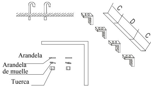
5.3.3 La placa de montaje en los soportes para techo garantizan la seguridad y la fijación (utilice los pernos pegados al techo como soportes. Utilizando los soportes de techo para colgar del mismo, la posición de la placa de montaje se puede ajustar en el límite de 100mm.
