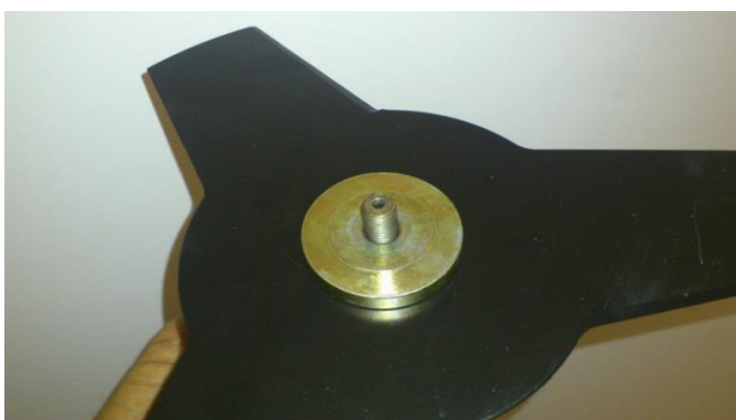
Anilha de fixação exterior do disco colocada de forma a fixar o disco.
