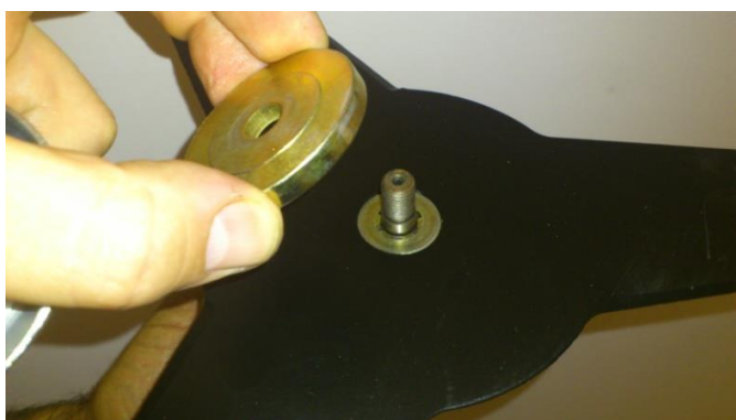
Colocação da anilha de fixação exterior com a parte oca virada para o disco.
