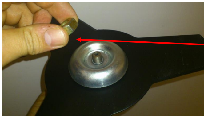
Colocación de la tuerca de apriete del disco
