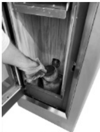
Fig. 31 - Extracción del brasero
